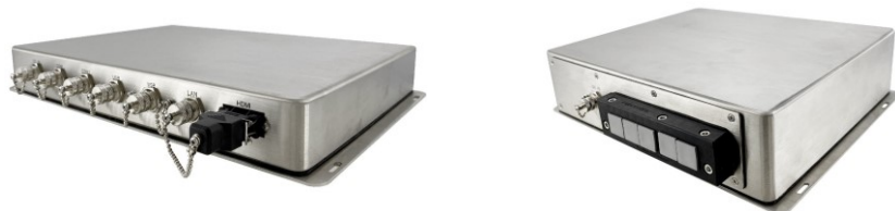
図1. WTC-8J0 の M12 メタルコネクタ(左上)とケーブル・グランド方式 I/O ポート(右上)
