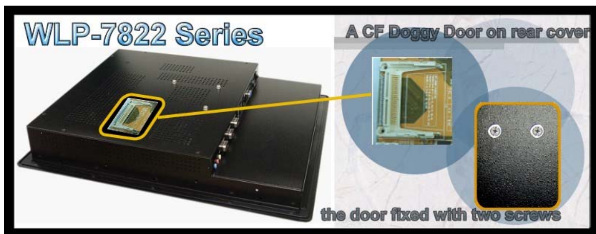
図 4. カスタマイズ例： OS 起動用の CF を容易に交換可能とするための小窓を設置
