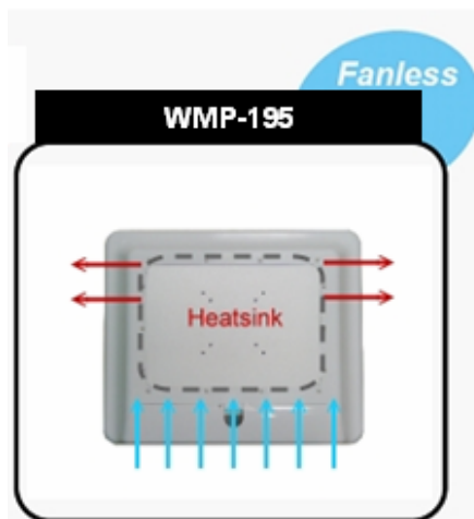
図： Wincomm 独特のファンレス熱処理設計
