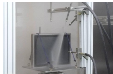
写真: IP69K スチームジェット放水テスト
